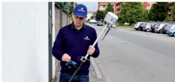
Очень просто производить измерения под углом. Электронные датчики позволяют вносить поправки в координаты при наклоне прибора.
