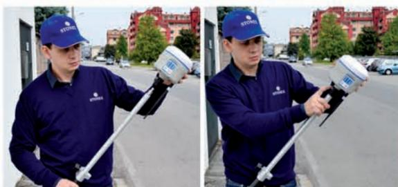
Одной кнопкой приёмник можно установить и снять с вехи.
