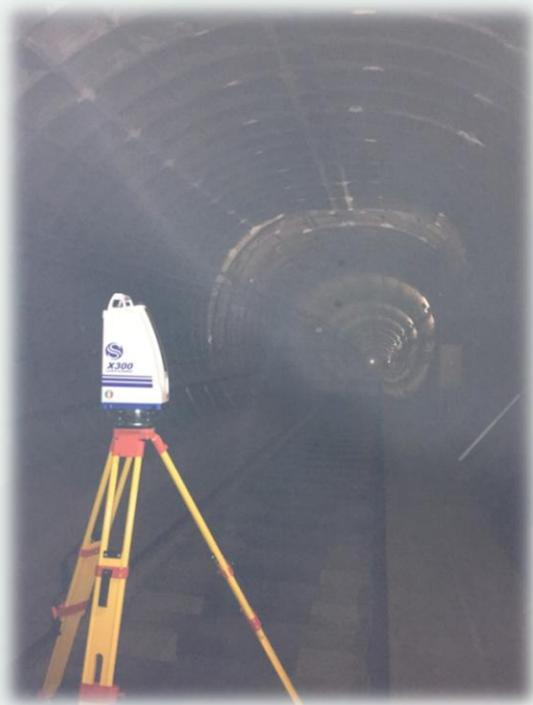
Съёмка тоннеля выполнялась с использованием технологии наземного лазерного сканирования сканером Stonex X300.
